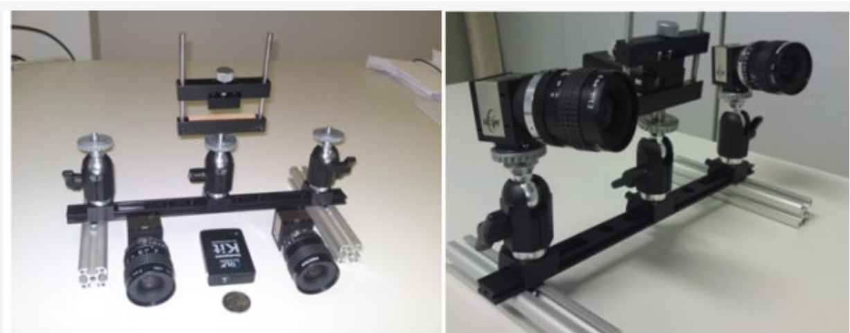
Abbildung 1: einzelne Sensorkomponenten (links) und aufgebautes Sensorsystem (rechts)
