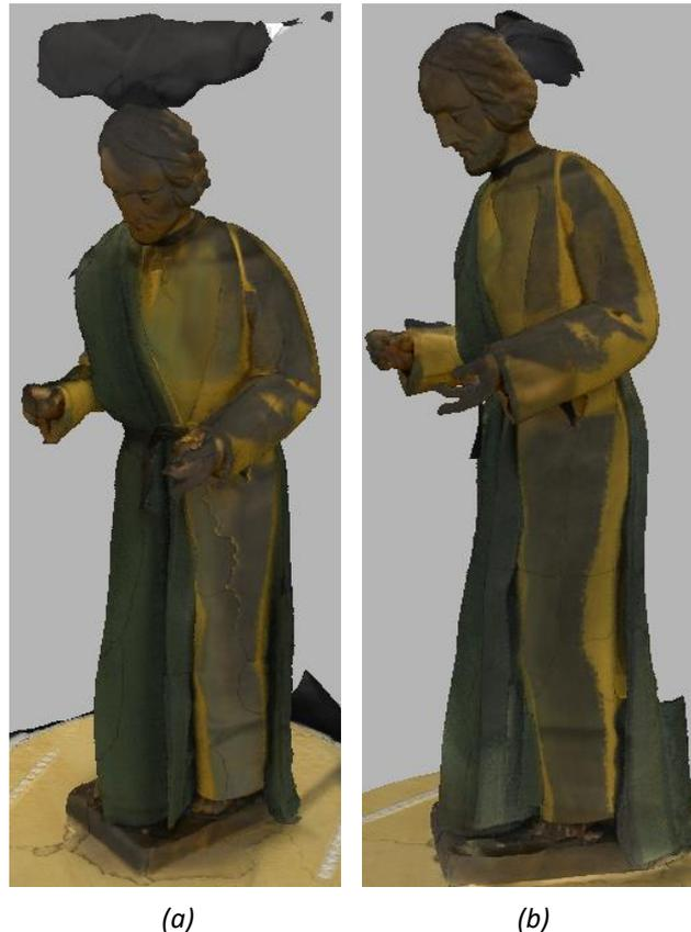
Abbildung 19: Fehlerhafte vermaschte Punktwolken mit ReCap 360 generiert, Bilder im 5° (a) und im 10° Winkel (b)
