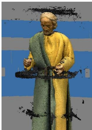
Abbildung 13: Zusammengefügte Punktwolke aus sechs einzeln generierten Punktwolken
