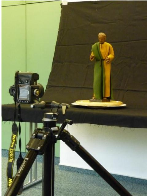
Abbildung 5: Aufnahme mit Drehteller und stationärer Kamera (Foto: Jakob Schmidt)
