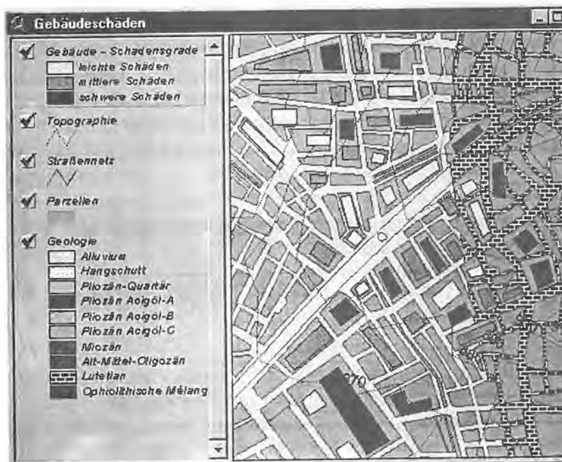
Abbildung 2: Visualisierung der Schadensgrade von Gebäuden
