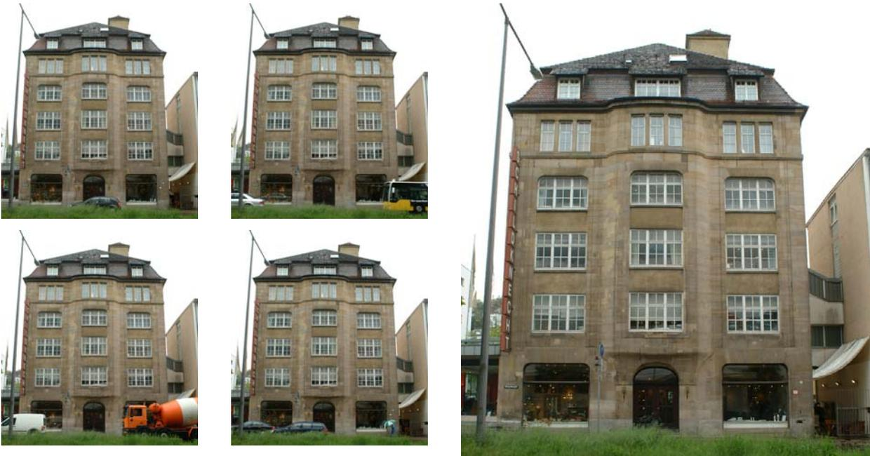
Abbildung 6-10: Vier Fassadenbilder, aufgenommen von einem festen Standpunkt auf der gegenüberliegenden Straßenseite. Verkehr und Fußgänger verdecken den unteren Teil der Fassade (links). Das resultierende Bild enthält nur den statischen Hintergrund (rechts). (aus [Böhm 2004])
