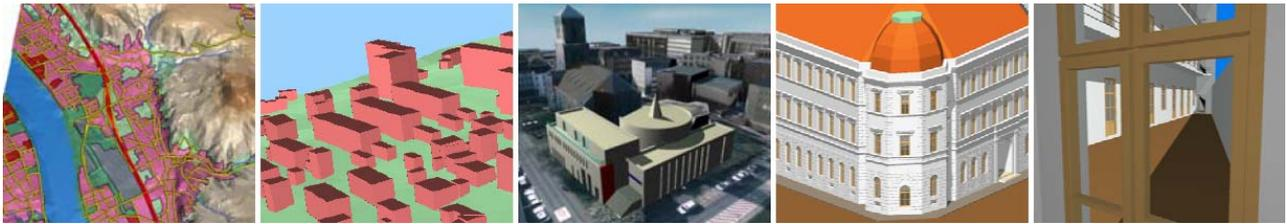
Abbildung 2-10: 3D-Stadtmodelle in den Detailstufen 0 bis 4 (von links nach rechts) (aus [Kolbe 2006]).
